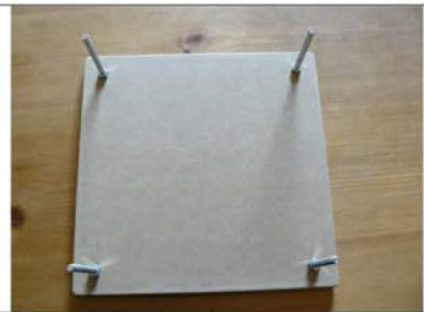
Zet de stootdoppen op de bouten en druk het plankje door de bouten. Draai de schroef erop.
