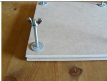
Breng het tweede plankje op de bouten en steek rondellen op de bouten, daarna de vleugelmoeren.
